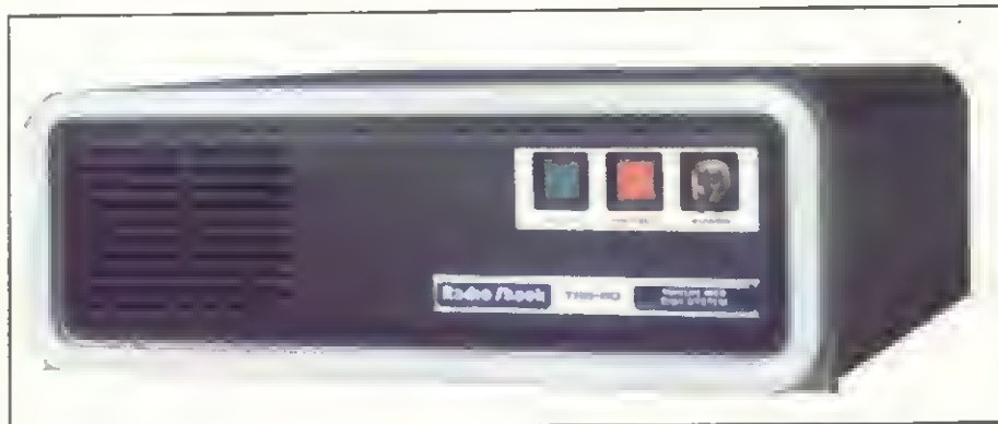
Este disco rígido para TRS-80 pode ser expandido de 12 MB até 48 MB.
